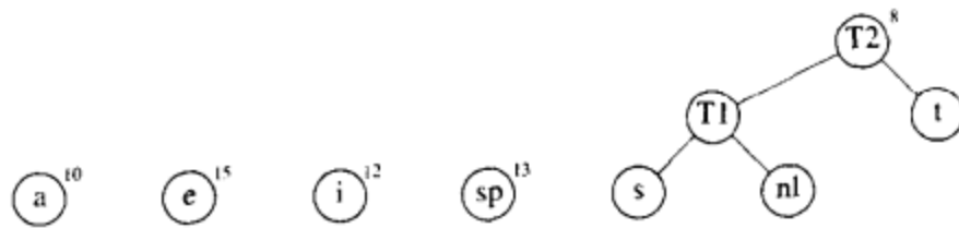
图 10-15 第二次合并后的哈夫曼算法
