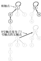
图 1.5.4 quick-union 算法概述
