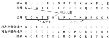
图 2.3.1 快速排序示意图
