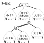
图 3.3.12 由一条红色左链接相连的两个 2- 结点表示一个 3- 结点（另见彩插）
