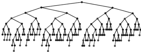
图 3.3.27 使用随机键构造的典型红黑树，没有画出空链接（另见彩插）
