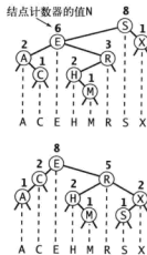
图 3.2.3 两棵能够表示同一组键的二叉查找树
