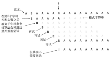
图 5.3.4 文本字符串的指针在子字符串查找中的回退
