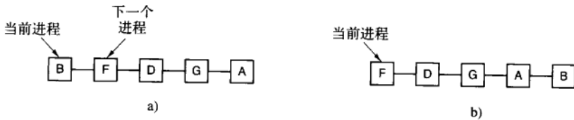
图2-41 轮转调度：a) 可运行进程列表，b) 进程B用完时间片后的可运行进程列表
