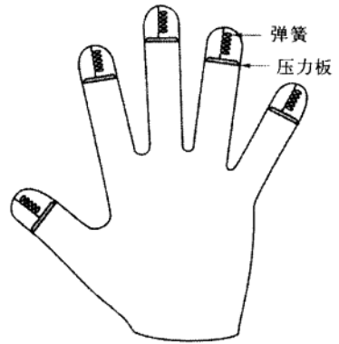
图9-21 一种测量手指长度的装置
