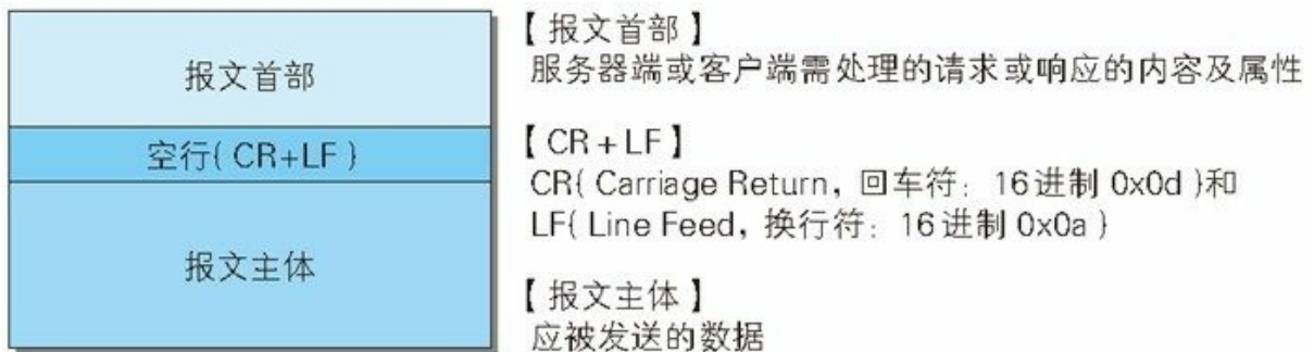
图：HTTP 报文的结构
