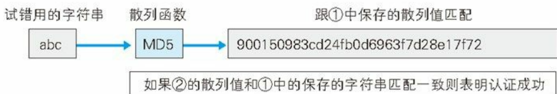
图：破解已加密的密码
