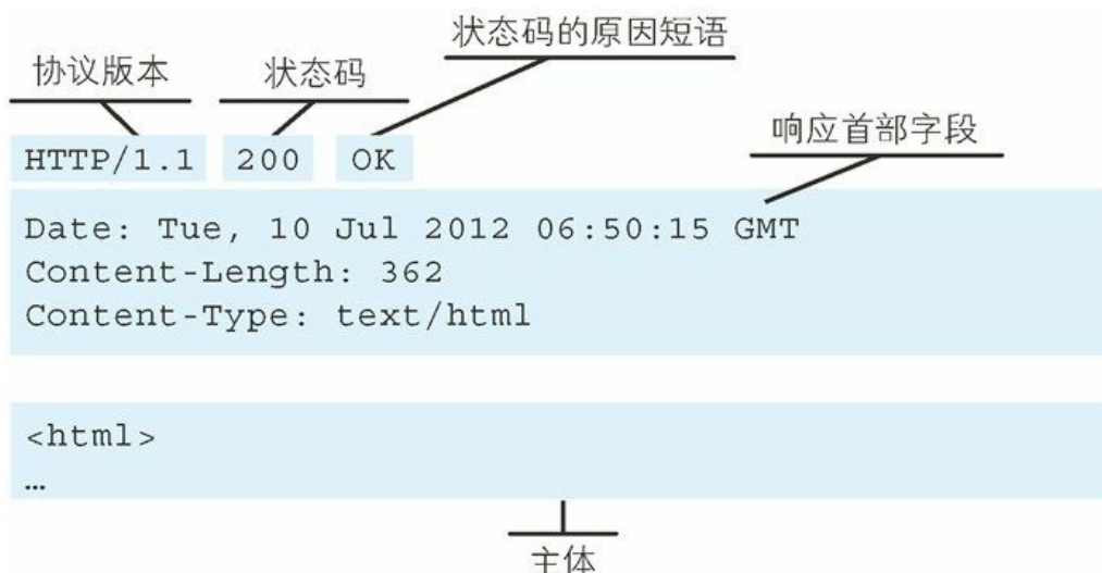
图：响应报文的构成
