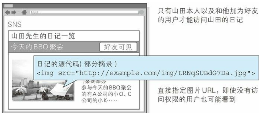
图：强制浏览导致安全漏洞的案例
