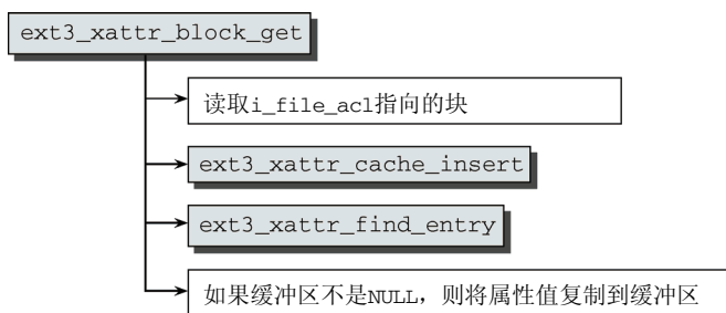
图11-7 ext3_xattr_block_get的代码流程图
