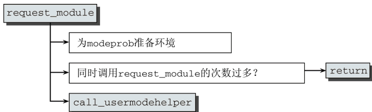
图7-7 request_module的代码流程图
