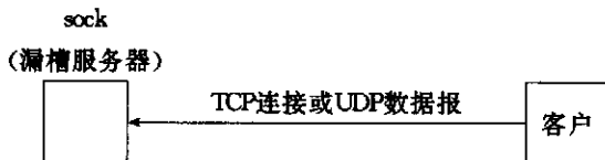
图 C.3 作为漏槽服务器的 sock 程序
